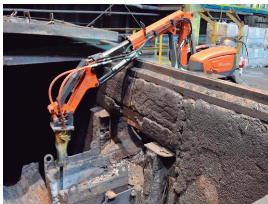
DXR 310 による製鋼工場のスラグ除去作業の様子（スロバキア） P3 オプション装着 P12 →
